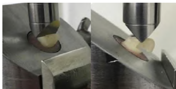
Figuras 8 y 9. Prueba de fuerza de ruptura en máquina de ensayo universal.
