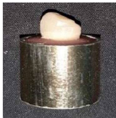
Figura 7. Muestra en su receptáculo para el ensayo en máquina de prueba.
