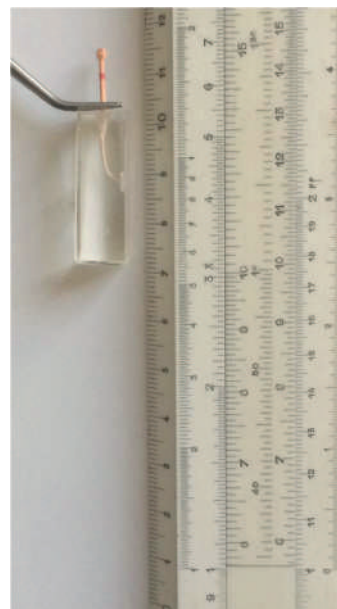
Figura 6. Prueba del ajuste de los conos de gutapercha. El cono de gutapercha sujeto por una pinza para algodón se encuentra contiguo a la regla respectiva, a 10 cm de altura.
