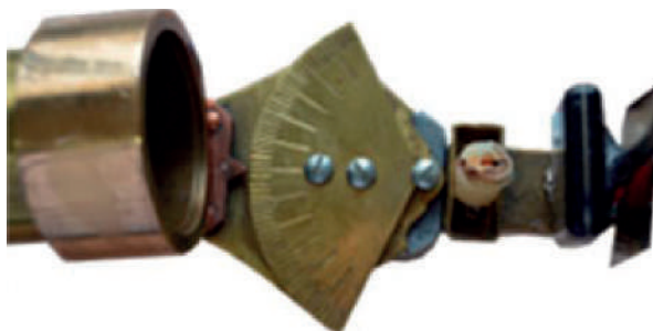
Figura 1. Aparato diseñado para el posicionamiento del diente y el control de la angulación en sentido horizontal.
