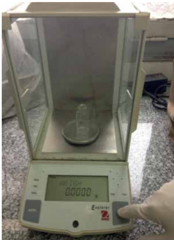
Figura 3. Pesaje de frascos viales en balanza de precisión Ohaus Explorer.
