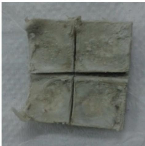
**Figura 4.** Muestra fijada y seccionada para ser analizada.
