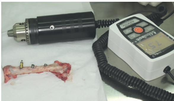
**Figura 9.** Torquímetro Mark-10 e implante con portaimplante colocado para la medición de torque de desinserción.
