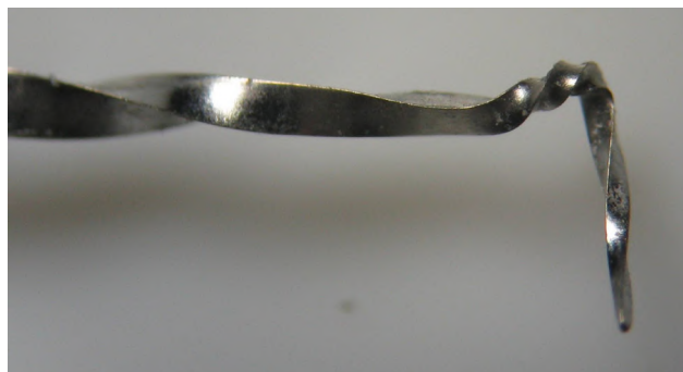
Figura 1. Deformación plástica de lima RaCe 15/06 X40.
