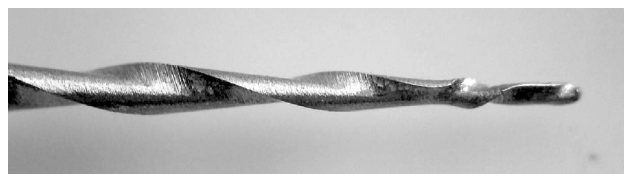
Figura 3. Deformación plástica antes de la fractura de lima MTwo 20/06 X40.
