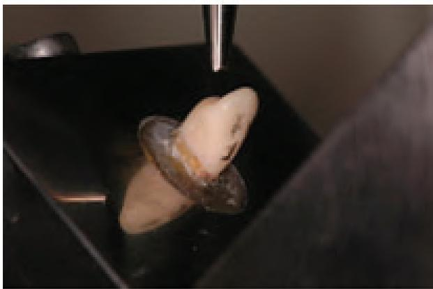
Figuras 6-7. Dispositivo fabricado para acoplar a la máquina y aplicar la carga a las muestras a 45°.
