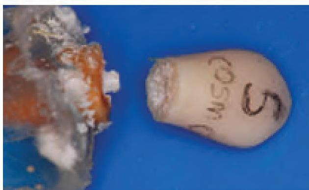
Figuras 8-10. Ejemplo del resultado del ensayo de una de las muestras de los Grupos 1, 2 y 3 ante la carga máxima aplicada. Obsérvense los diferentes tipos de fractura de los postes.
