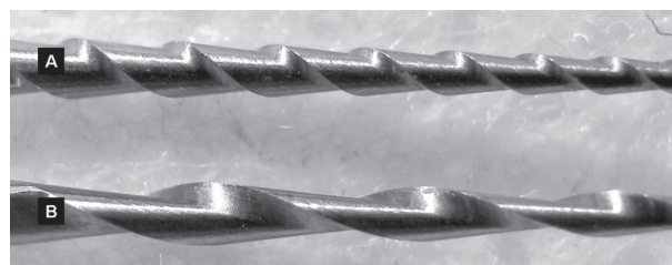
Figura 2. A) Lima Niti TEE #30/04, observar un ángulo helicoidal y un pitch constante. B) Lima Mtwo 30/05, observar un ángulo helicoidal y un pitch variable.
